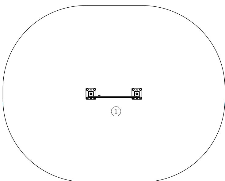
Utilização do equipamento sujeito a condições vigiadas; Zona de segurança: Área mínima requerida pela norma EN 1176-1,3
