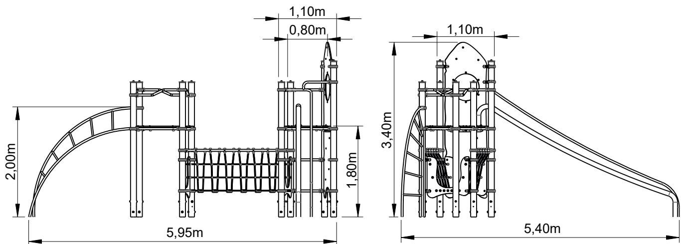
Utilização do equipamento sujeito a condições vigiadas; Zona de segurança: Área mínima requerida pela norma EN 1176-1,6
