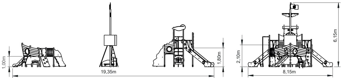
Utilização do equipamento sujeito a condições vigiadas; Zona de segurança: Área mínima requerida pela norma EN 1176-1,6
